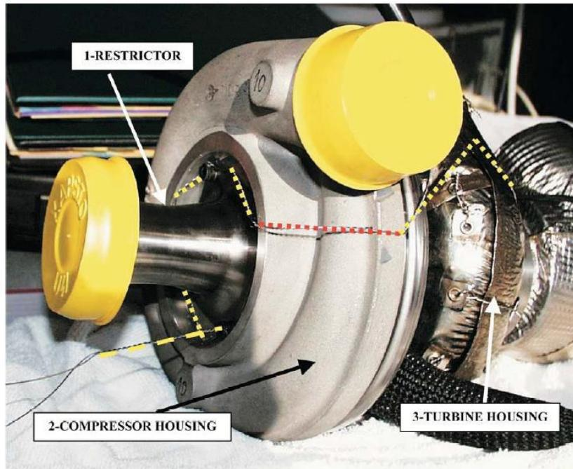
Restruktoram jābūt izgatavotam no viendabiga materiala un to jāparedz caururbt tikai montažai un plombešanai, kas javeic starp montešanas skrūvem, starp restruktoru (vai restruktora/kompresora korpusa stiprinajumiem), kompresora korpusu (vai korpusa/atloka stiprinajumu) un turbinas korpusu(vai korpusa/atloka stiprinajumu) skatit zimejumu.
